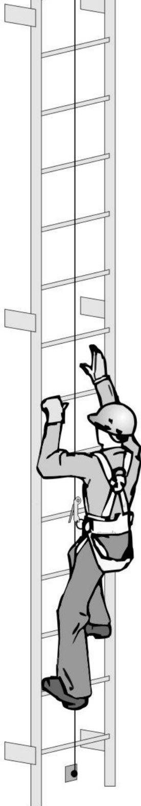
escalera fija >7 m.
